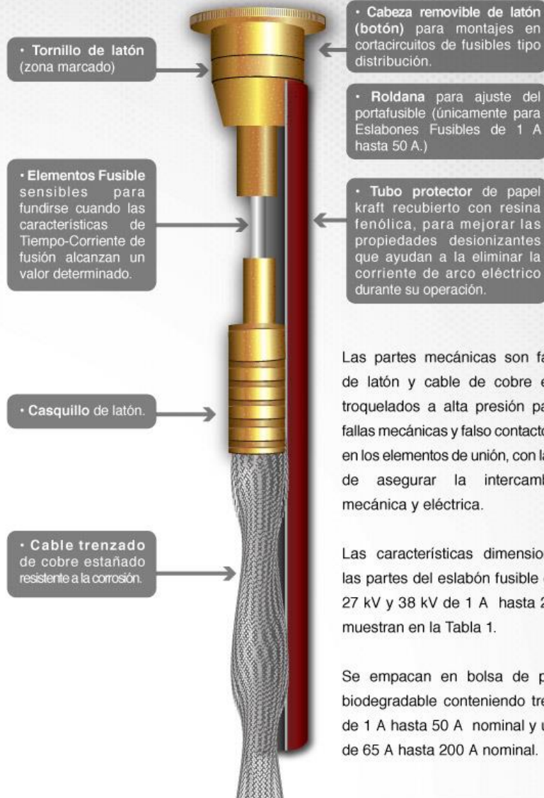
Figura 1: Partes componentes del eslabón fusible.
